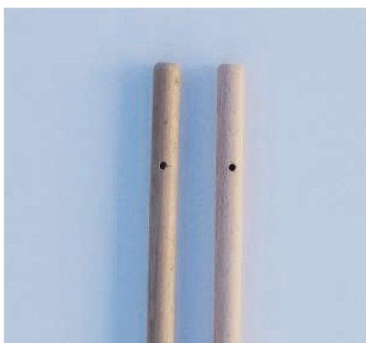
3. Auf der anderen Seite der Rundhölzer wird circa 7 cm vom Ende entfernt ein Loch für die Schraube gebohrt.
