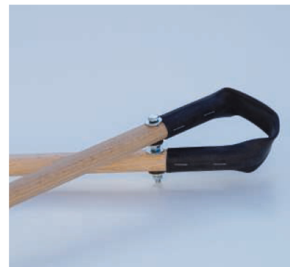
5. Mittels des Fahrradschlauches kann der Pirschstock am Vorderschaft fixiert werden und ist somit schnell einsatzbereit.
