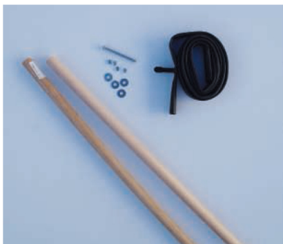
1. Material: Man benötigt für den Bau zwei Rundhölzer, eine Schraube, vier Unterlegscheiben und vier passende Muttern, dazu ein Stück eines alten Fahrradschlauches.
