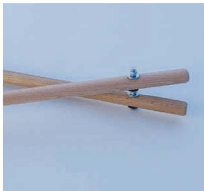
4. Die Schenkel werden so zusammengeschaubt, dass das Auf- sowie Zuklappen des Pirschstockes möglich ist.
